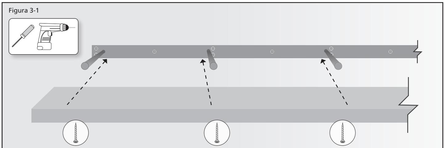
Alinee el soporte de montaje con los orificios preperforados en la parte posterior de la estantería y deslice en su lugar. Localice los tornillos de acabado de 1-1/8 pulgadas y, utilizando un taladro, enrosque los orificios preperforados en la cara del estante (Figura 3-1).
